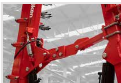
Sécurité mécanique - Verrouillage de sécurité du transport sur les ailes
