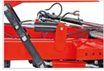
Hidrolik Piston İle Açılabilir
