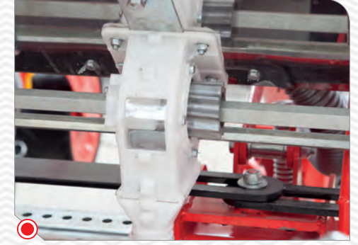
Gübre Atım Sistemi
