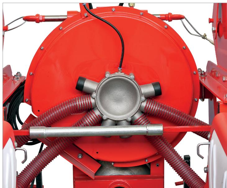
Вакуумная система должна быть надежной во время работы. Наш вал РТО привода системы вентилятора на 540 об/мин, надежен даже в часы высоких работ, и бесшумен для удобства пользователя.
