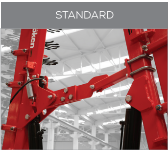
SÉCURITÉ MÉCANIQUE - TRANSPORT VERROUILLAGE DE SÉCURITÉ SUR LES AILES
